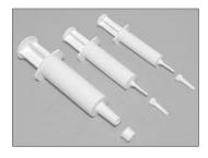
Diese Kunststoff-Pipetten aus einem Stück werden dort verwendet, wo die Möglichkeit der Präsenz von Glasstückchen vermieden werden muss.
