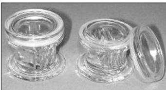
Für Arbeiten mit kleinen Chemikalienmengen gibt es den COPLIN-Trog in einer Ausführung mit ca. 15 ml Volumen, in dem vertikal vier einzelne (bzw. acht Rücken) Deckgläser der Größe 20 mm x 20 mm bis 22 mm x 22 mm Platz finden. Trog wird mit einem Glasdeckel geliefert.
