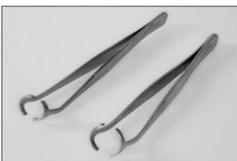
Zum Ergreifen zylindrischer Probenteller, mit starken Backen:
