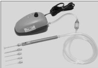
Dieses System, zum Anheben kleiner leichtgewichtiger Teile, wird ebenfalls über das Verschießen mit dem Finger einer Öffnung gesteuert. Die Probenoberfläche muss trocken und darf nicht korrodiert sein.
