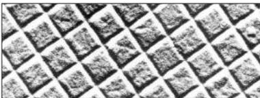
Kreuzgitter im Winkel von 90° zueinander, bei 2160 Linien pro Millimeter, liefern zusätzliche Genauigkeit beim Vergrößerungstest und helfen beim Erkennen von Verzerrungen. Diese Replikas sollten nicht zu lange hohen Strahlströmen ausgesetzt werden.
