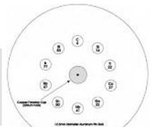
**659-6** XCS-6 EDS Kalibrierstandard mit SS316,  $\text{SiO}_2$ , Mn, B, C und 200 mesh Cu-Netzchen
