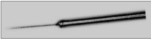
J410 Wolfram-Spitzen mit Nickelschaft, der Spitzenradius beträgt 0,5\ \mu\text{m} , der Winkel 13^\circ , 10 Stück
