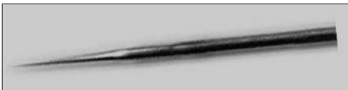
J413 Autoprobe 250 Wolfram-Spitzen, der Spitzenradius beträgt < 0,5\ \mu\text{m} , der Winkel 10^\circ , 10 Stück
