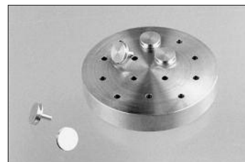
G3698 REM-Präparationshalter für 12,5 mm Ø – Stift-/12,5 mm Ø zylindrische Teller
