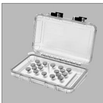
16799 Pelco® X-Treme Aufbewahrungsschachtel für 18 Stiftprobenteller 12,5 mm Ø, oder 8 Stiftprobenteller 25 mm Ø, oder 2 Stiftprobenteller 32 mm Ø, oder 2 Stiftprobenteller 38 mm Ø oder 2 Stiftprobenteller 50 mm Ø. Diese Schachtel besteht aus einem äußerst stabilen Polycarbonat. Sie ist durch Verschlusslaschen und einem Dichtungsring wasserdicht und staubgeschützt.
