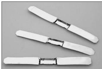
In diese Schiffchen können mehrere Blenden eingelegt werden, um dann in einer Vakuumkammer hellrotglühend erhitzt zu werden. Dimensionen: 76,2 mm x 7,9 mm, Trog: 4,8 mm x 12,7 mm x 0,8 mm Trogtiefe. Dicke des Mo-Bleches 0,05 mm.
