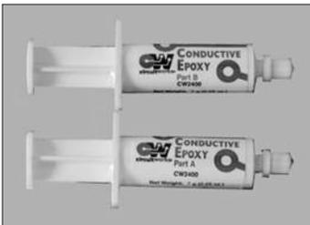
Zum dauerhaften Zusammenfügen von Keramik, Metall, Glas und vielen Kunststoffen. Mit der Zweikomponenten-Mischung (Silber in „aralditartigem“ Harz) werden Klebestellen hoher Leitfähigkeit erzeugt. Die Mischung bleibt 10 Minuten lang verarbeitungsfähig. Härtet innerhalb von 24 Stunden bei Raumtemperatur aus, innerhalb von 30 Minuten bei 100 °C.
